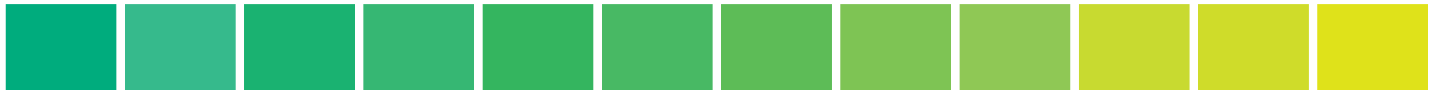
PANTONE 3278 CS C:91 M:0 Y:70 K:0 PANTONE Green CS C:69 M:0 Y:60 K:0 PANTONE 340 CS C:80 M:0 Y:76 K:0 PANTONE 3405 CS C:72 M:0 Y:74 K:0 PANTONE 347 CS C:75 M:0 Y:86 K:0 PANTONE 354 CS C:69 M:0 Y:82 K:0 PANTONE 361 CS C:65 M:0 Y:89 K:0 PANTONE 368 CS C:54 M:0 Y:89 K:0 PANTONE 375 CS C:48 M:0 Y:87 K:0 PANTONE 382 CS C:26 M:0 Y:98 K:0 PANTONE 389 CS C:23 M:0 Y:99 K:0 PANTONE 396 CS C:16 M:0 Y:100 K:0
